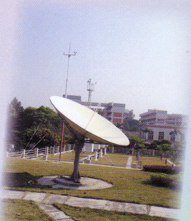
廣州氣象衛星地面站內鑊形天線，用以接收氣象衛星傳送回來的資料。
